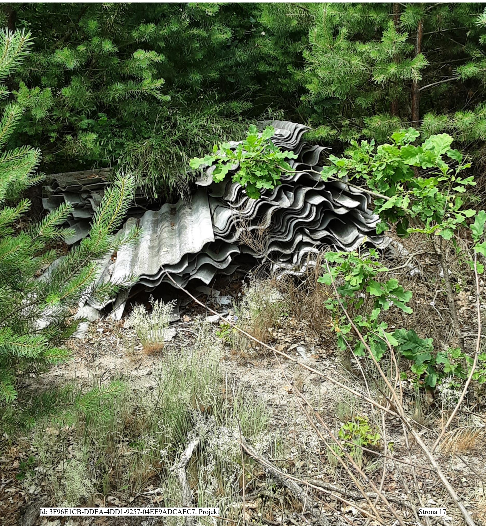
Fot. 2. Nielegalne składowanie wyrobów azbestowych.
